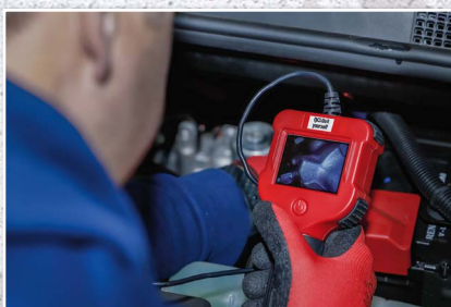
Endoskop-Farbkamera mit TFT-Monitor | Kamerakopf Ø 5,5 mm
