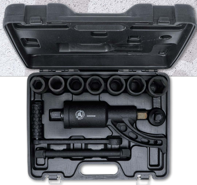
Drehmoment-Vervielfältiger-Satz | Antrieb Innenvierkant 25 mm (1") | 3200 Nm
